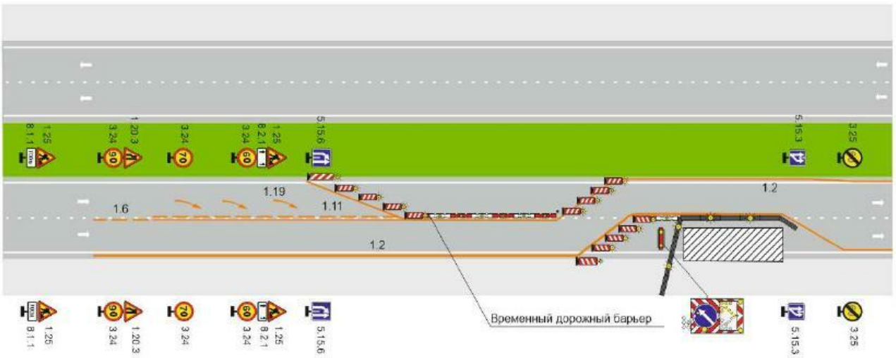
Рисунок Д.27 – Размещение ТСОДД при производстве долгосрочных работ на проезжей части дороги с четырьмя полосами
